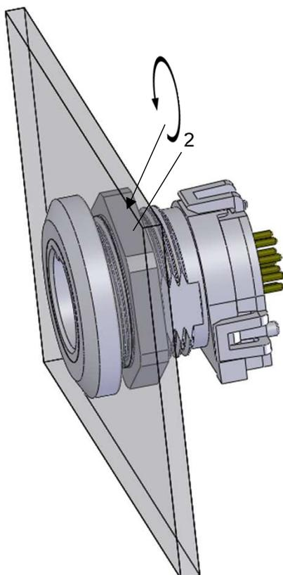
Sechskantmutter (2) bündig an Frontblende anlegen und mit geeignetem Werkzeug anziehen. Gerätedose an der Schlüssel­fläche gegengehalten
